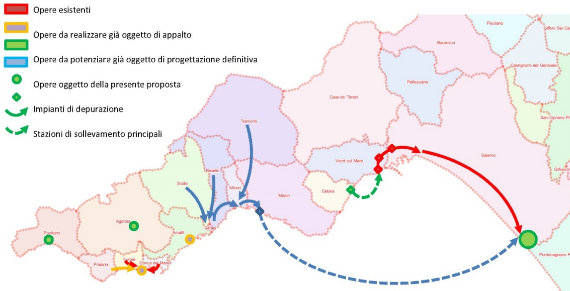
Figura 1. Schema finale di gestione dei reflui nel territorio della Costa d'Amalfi
